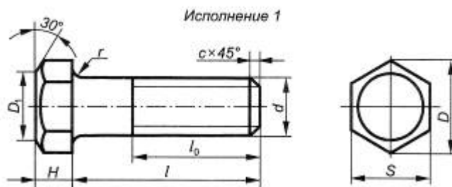
Рис. 2.30. Болт с шестигранной головкой нормальной точности исполнения 1
